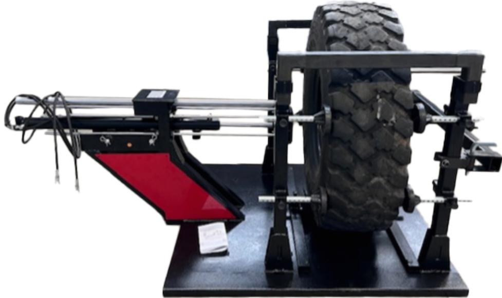
L'équipement offre **une grande précision et un excellent contrôle des opérations**, grâce à des systèmes de maniement conçus pour fonctionner de manière progressive et contrôlée, permettant à l'opérateur de gérer chaque phase de travail avec précision et en toute sécurité. Les solutions techniques adoptées permettent de maintenir un **contrôle constant** pendant l'extraction du système Run Flat, réduisant ainsi le risque d'endommagement du pneu et des composants internes.
